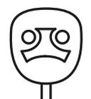
**Tesla Supercharger:** Weist eine große Ähnlichkeit zum Typ 2 Stecker auf, kommt allerdings nur bei Tesla-Modellen zum Einsatz. Er unterstützt allerdings eine höhere Ladeleistung bis 250 kW.
